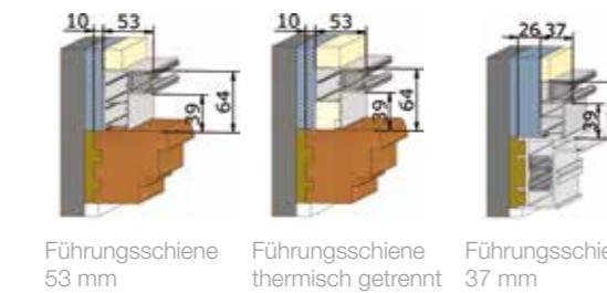
Führungsschiene 53 mm      Führungsschiene thermisch getrennt 53 mm      Führungsschiene 37 mm
