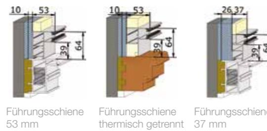
Führungsschiene 53 mm      Führungsschiene thermisch getrennt 53 mm      Führungsschiene 37 mm
